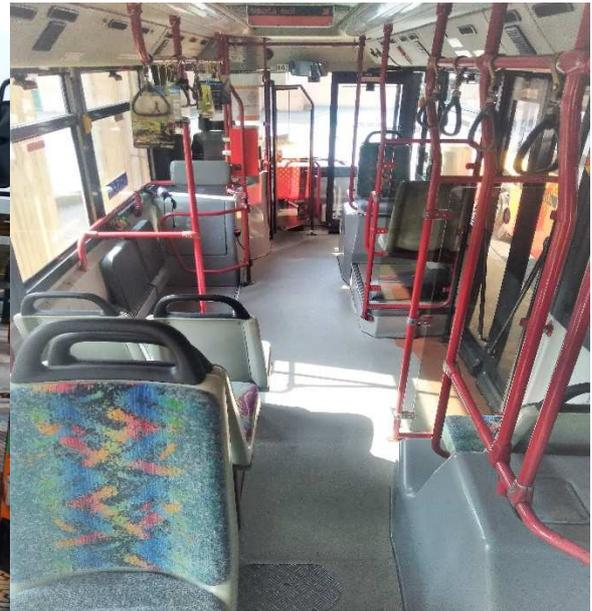
Condizioni generali: non buone, privo di alcuni componenti (radiatore, pompa iniezione), con cartelli indicatori di percorso (anteriore, laterale e posteriore), pedana disabili elettrica.
